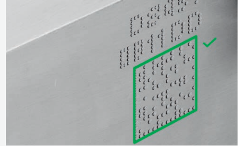
Metale kabartmalı işlenmiş veri matris kodlarını okuma - örneğin, otomotiv endüstrisinde
