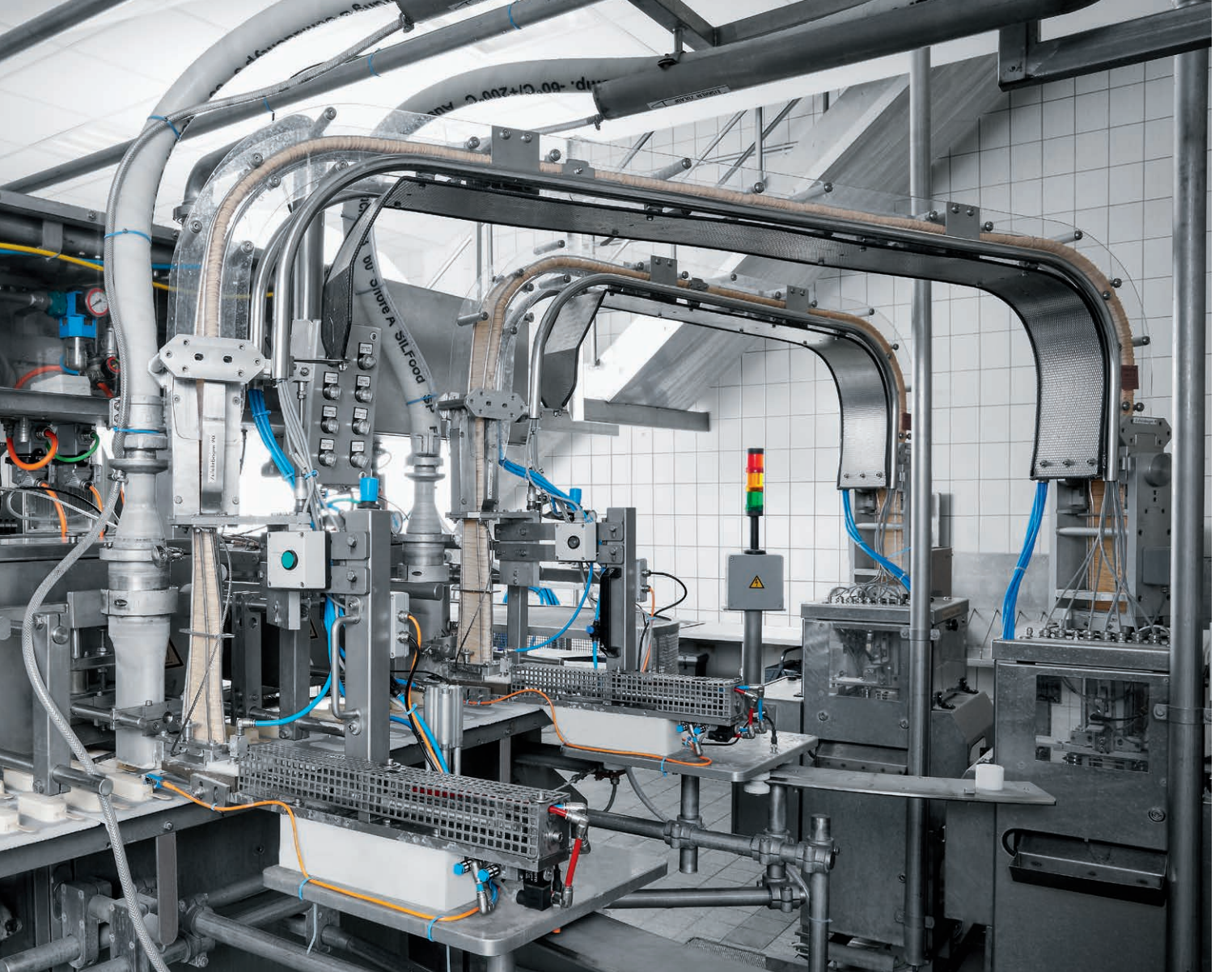
Aralıksız şekilde lezzetli dondurma üretimi. MSE6-E2M, sistemin bir durma noktasına gelmesi halinde basınçlı hava beslemesini keser ve etkili durum izleme yoluyla tüketimin daha da azaltılmasına yardımcı olur.
