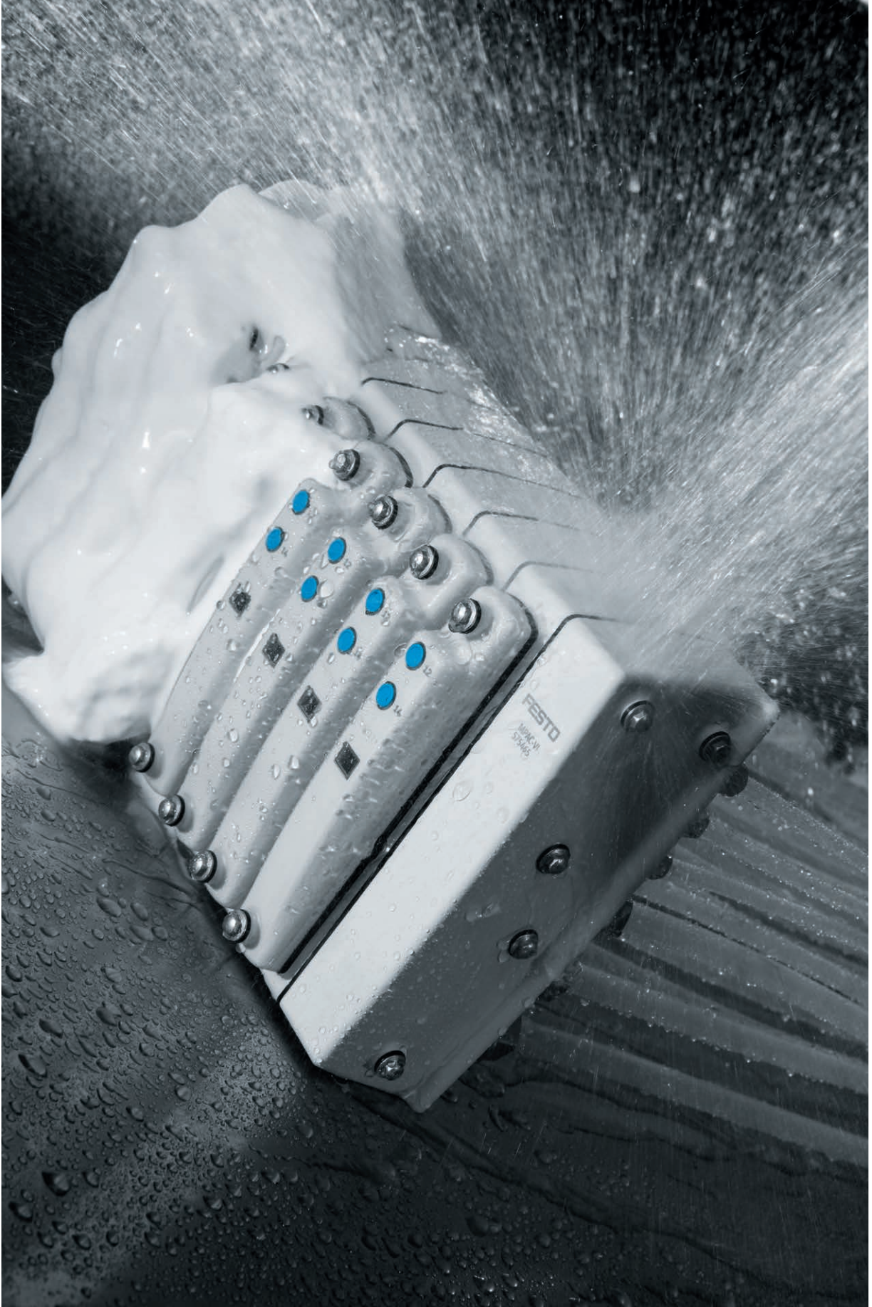
Sahada dađıtık montaj için ideal. Kir Tutmaz Tasarımlı valf adası MPA-C son derece güçlü olup IP69K korumasına, üstün aşınma dayanımına, FDA-uyumlu gövdeye ve NSF-H1 gres yağına sahiptir.
