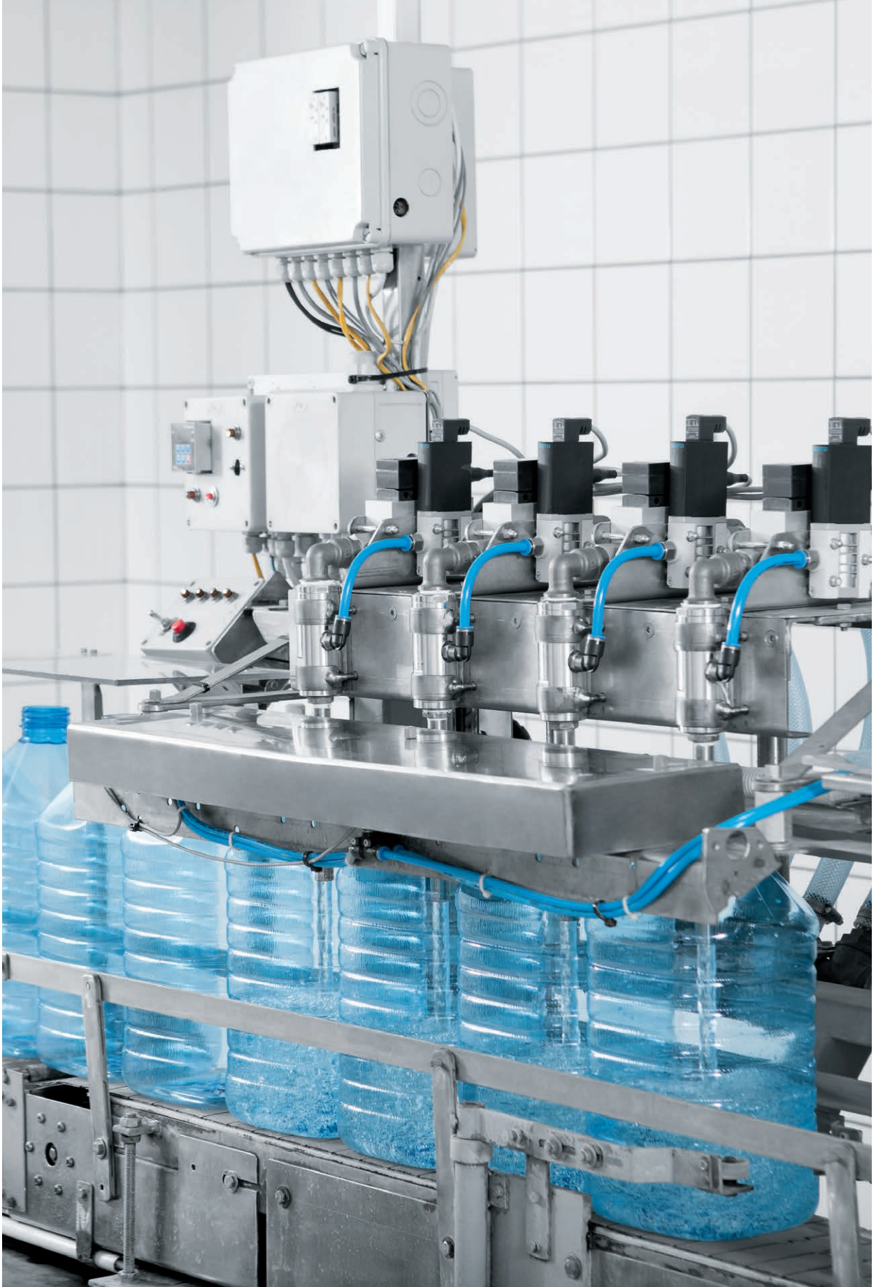
Festo'nun çözümlüyle 5 litrelik şişeler hızlı ve hassas şekilde dolduruluyor. Yenilikler: esnek valf VZQA ve hızlı valf MHE4
